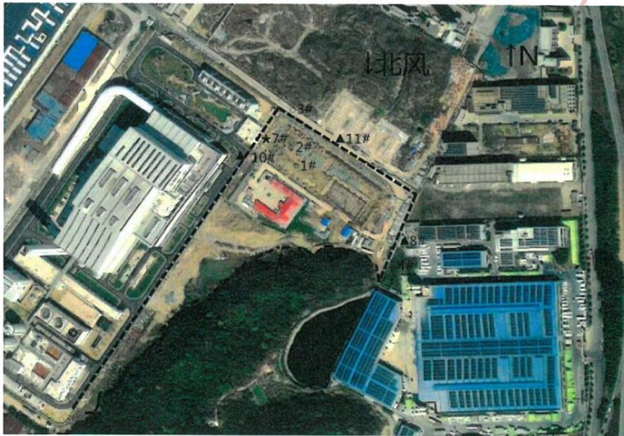
◎-有组织废气采样点; ○-无组织废气采样点; ★-废水采样点; ▲-工业企业厂界噪声检测点
